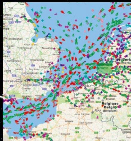
**VERWIRRUNG:** Die AIS-Signale von Schiffen, die von Satelliten mit ungerichteten Kupferantennen empfangen werden, überlagern sich häufig. Hier verspricht der neue „AISat“ einen deutlichen Fortschritt.
