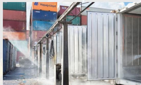
**WASCHANLAGE:** Reefer (Kühlcontainer) werden auf dem Containerwaschplatz mit Hochdruckreinigern gesäubert.
