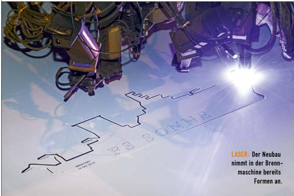
**LASER:** Der Neubau nimmt in der Brennmachine bereits Formen an.
