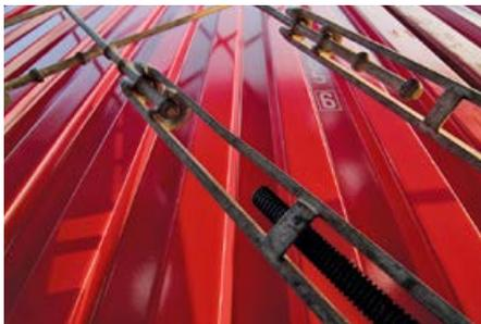
DETAIL: Zur Sicherung der Container werden die Laschstangen kreuzweise verschraubt.
