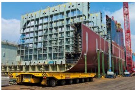
**SICHERHEIT:** Das Schiffssegment zeigt die Struktur des Schiffsrumpfs mit Schotten.
