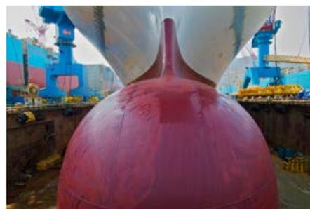
**NASE:** Der Bugwulst verstärkt durch sein Volumen den Auftrieb des Vorderschiffs.
