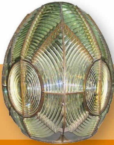
**LEUCHTTURM:** Diese Fresnell-Linse von 1870 ist 2,54 m hoch, hat einen Durchmesser von 1,98 m und wiegt imposante 1,5 Tonnen.
