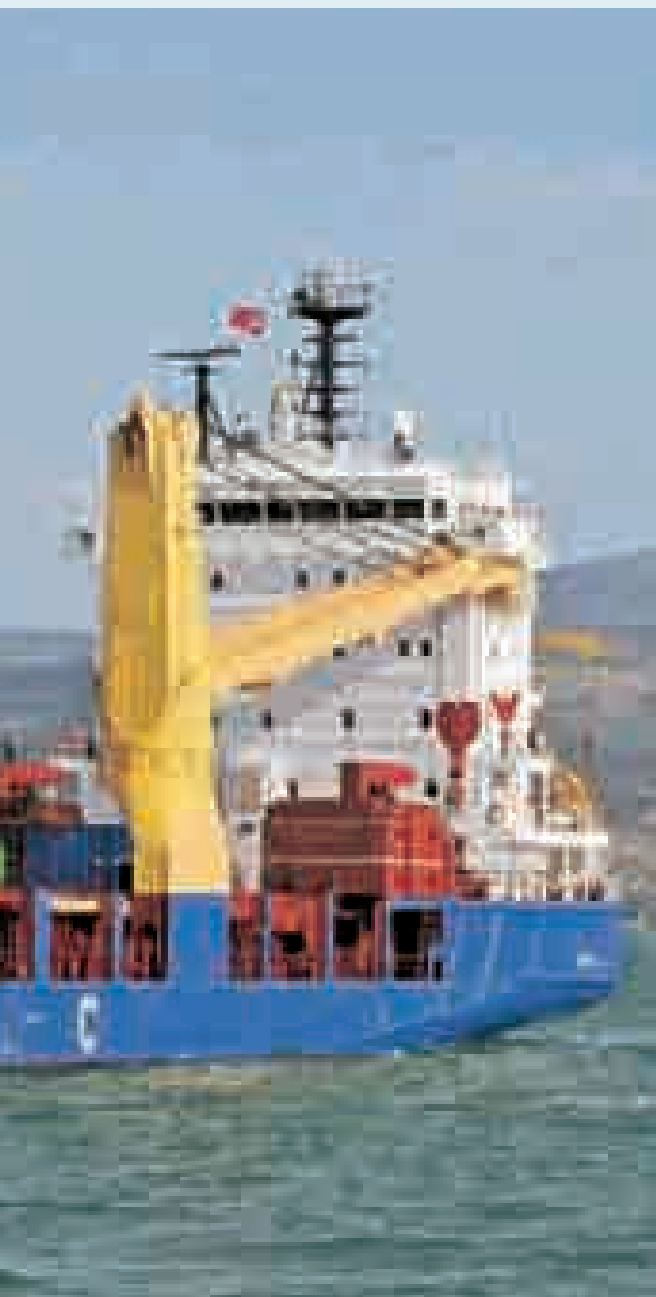
„BBC SWITZERLAND“: Der 601 TEU tragende Neubau der Leerer Reederei Briese ist für den Schwerguttransport ausgerüstet.
