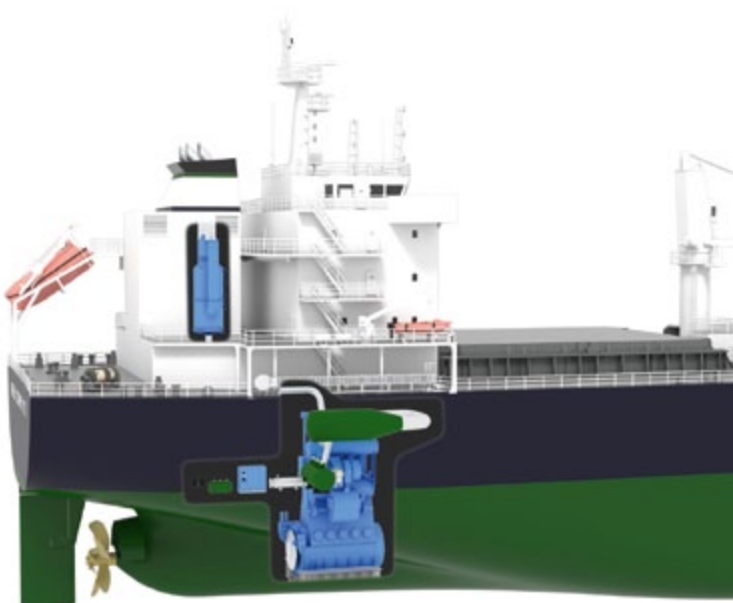
KONZEPT: Die DNV GL-Studie „Green Dolphin 575“ skizziert einen 190 Meter langen Handymax-Massengutfrachter mit fünf Frachträumen und Dual-Fuel-Antrieb, der die Common Structural Rules (CSR) erfüllt. Es ist eine Einhüllen- und Doppelhüllen-Konfiguration möglich.
