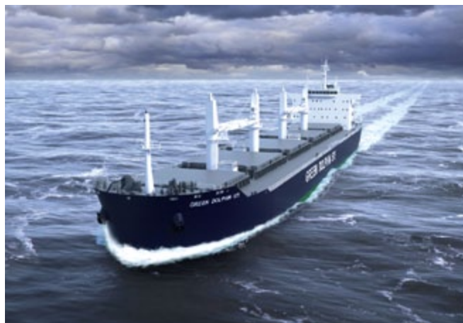
KONZEPT: Die DNV GL-Studie „Green Dolphin 575“ skizziert einen 190 Meter langen Handymax-Massengutfrachter mit fünf Frachträumen und Dual-Fuel-Antrieb, der die Common Structural Rules (CSR) erfüllt. Es ist eine Einhüllen- und Doppelhüllen-Konfiguration möglich.
