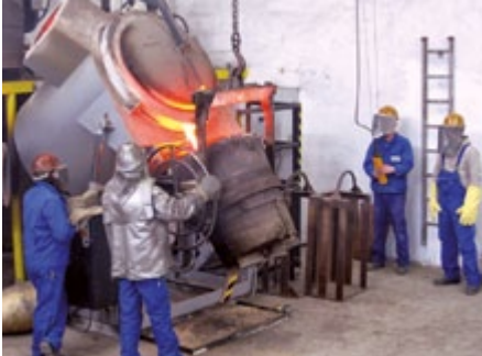
GIESSEREI: Die Propeller werden vor Ort geformt und gegossen.
