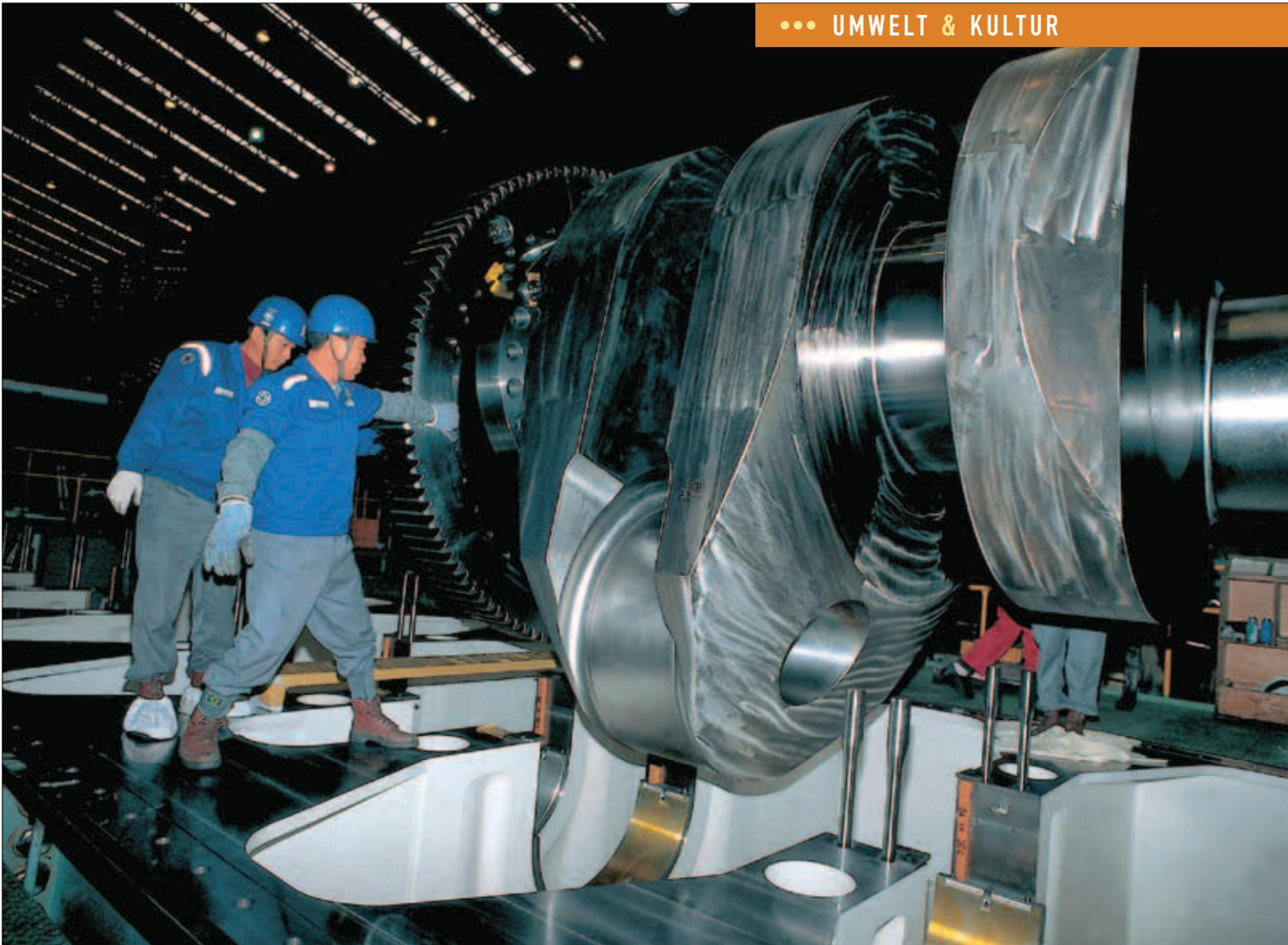
**PRÄZISIONSARBEIT:** Große Teile, wie hier die Kurbelwelle für ein Containerschiff mit mehr als 5.000 TEU, werden in Lizenz in Asien gefertigt.
