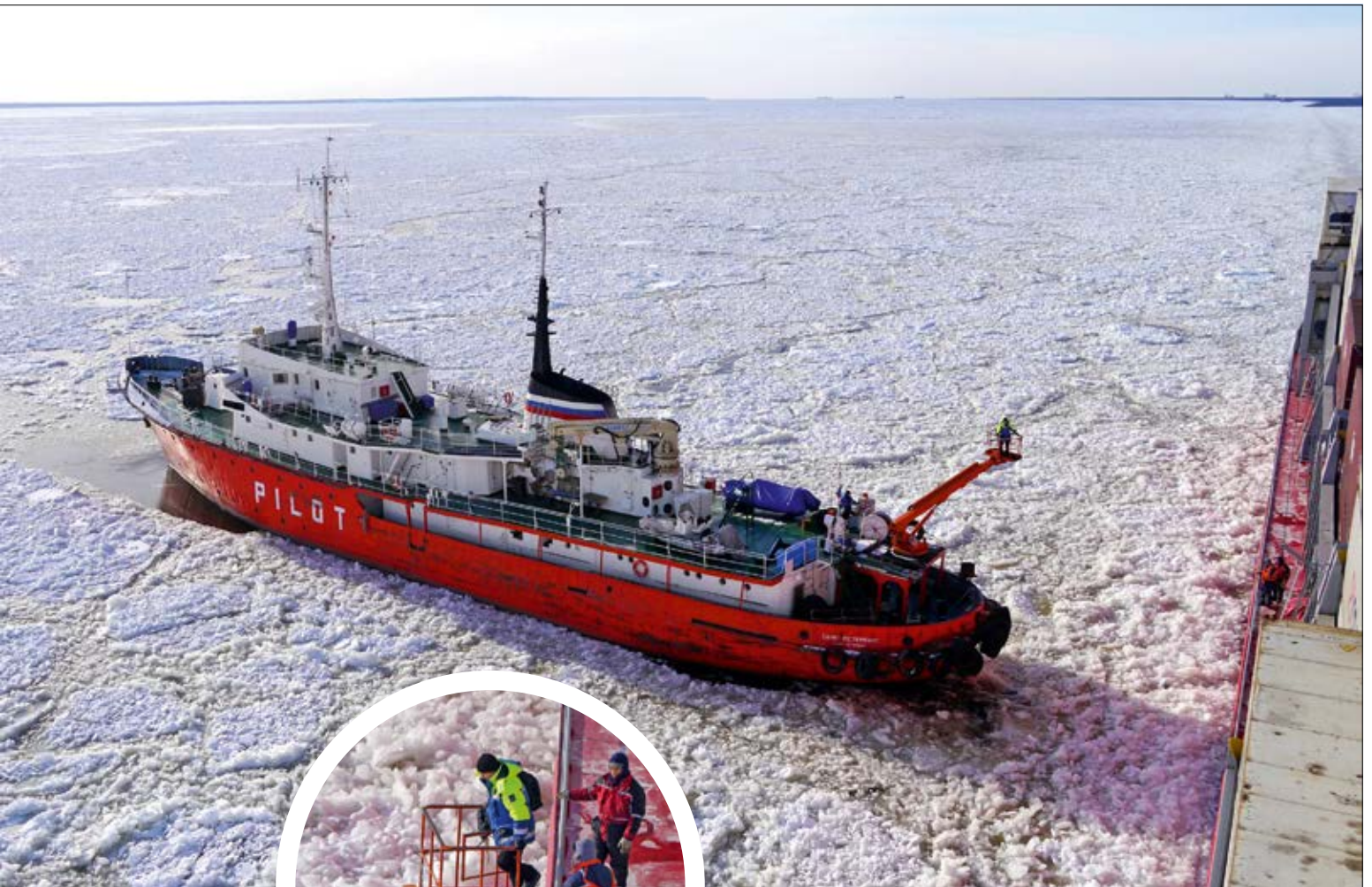
BALANCEAKT: In der freien Fahrrinne muss gestoppt werden, damit der Lotse übersetzen kann. Dazu nutzt er eine Hebebühne, weil das Tenderschiff wegen der Eisdicke nicht nah genug herankommt.
