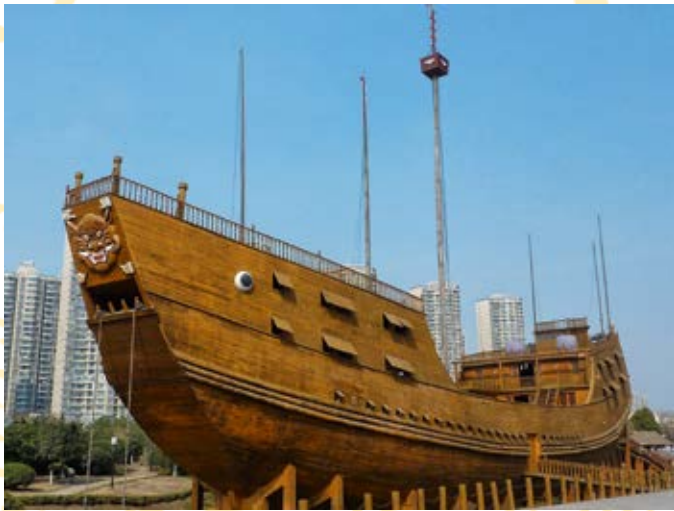
AUSSTELLUNG: Der „Treasure Boat Shipyard Site Park“ in Nanjing feiert Chinas Marco Polo. Der Themenpark befindet sich an der Stelle, wo sich die historische Longjiang-Werft befand, auf der Zheng Hes Schiffe entstanden. Das Modell in Originalgröße ist aus Beton und mit Holzplanken verkleidet.
