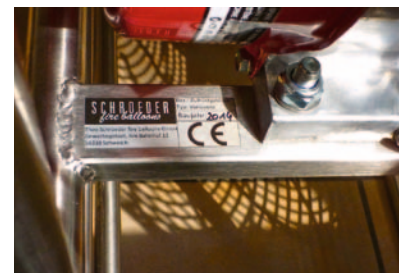
Das Aufrüstgebläse muss unbedingt mit einer CE-Kennzeichnung und einem Typenschild versehen sein.
