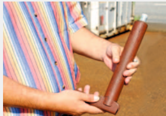
Der Federriegel nimmt gewaltige Kräfte auf – seinen Zustand kann man von außen nicht erkennen.
