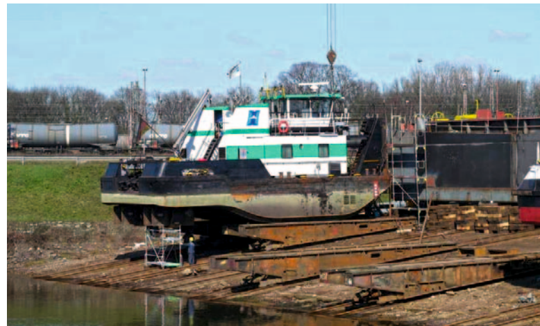
Bei Aufenthalt auf der Helling: Immer die Absturzgefahr beseitigen!
