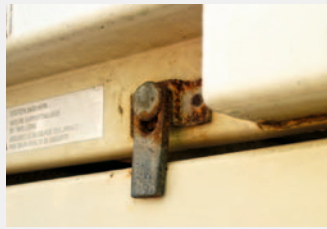
Die Fallhakensicherung hält das eingeklappte Stützbein auf der Auflage.
