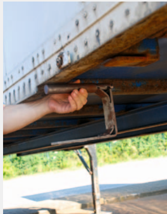
Die bewegliche Beinauflage verbiegt nicht so leicht, da sie ausweichen kann (der Stützbeinhaken ist eine Alternative).
