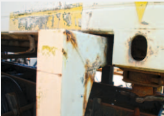
Stützbeine werden hart beansprucht und oft nachlässig behandelt.
