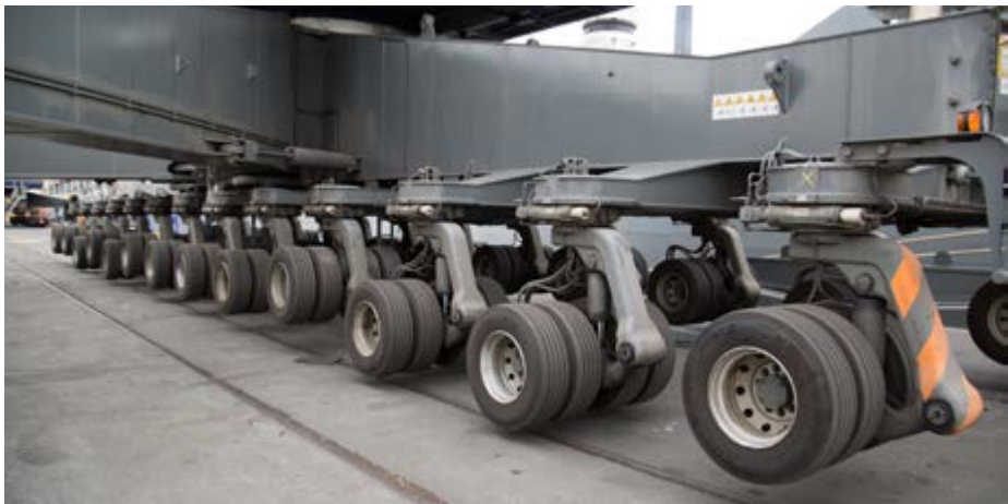
Wie ein Tausendfüßler sehen die Achsen des Hafenmobilkrans aus
