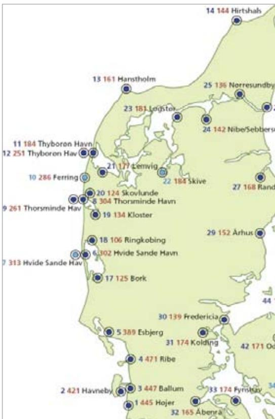
Abb. 9: Für die Nordsee relevante Pegel aus den „Hochwasserstatistiken“. Die roten Werte geben 50-jährige Extremwasserstände an, dunkelblaue Punkte stehen für Orte mit guter Messdatenlage, hellblaue für Orte mit unsicherer Datenlage aufgrund kürzerer oder lückenhafter Messreihen (< 15 Jahre) (HØJVANDSSTATISTIKKER 2007)
