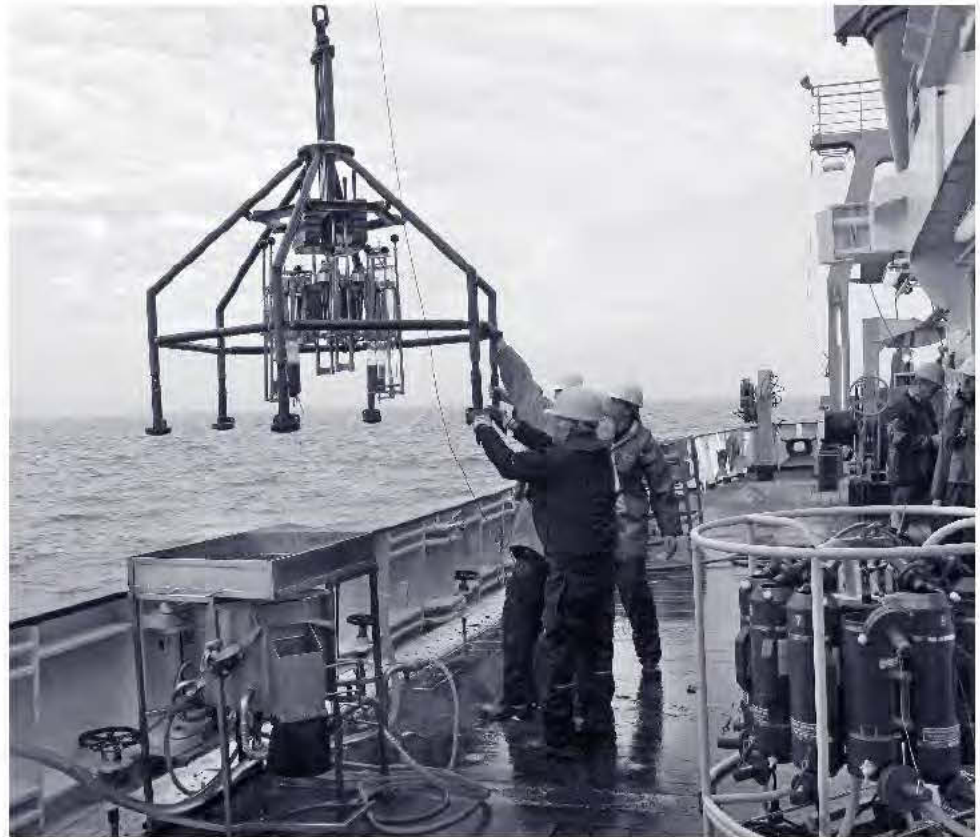
Probenahme von Sedimentkernen mit einem Multicorer (Stechrohr)
