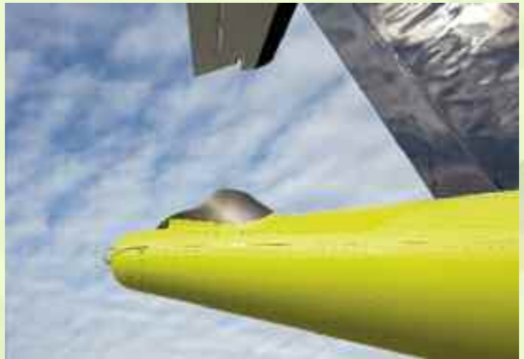
Das APU kann Flugzeuge während der Abfertigung mit Strom und klimatisierter Luft versorgen
