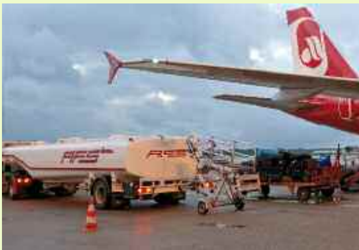
Für die Betankung von Flugzeugen werden spezielle Tankfahrzeuge eingesetzt
