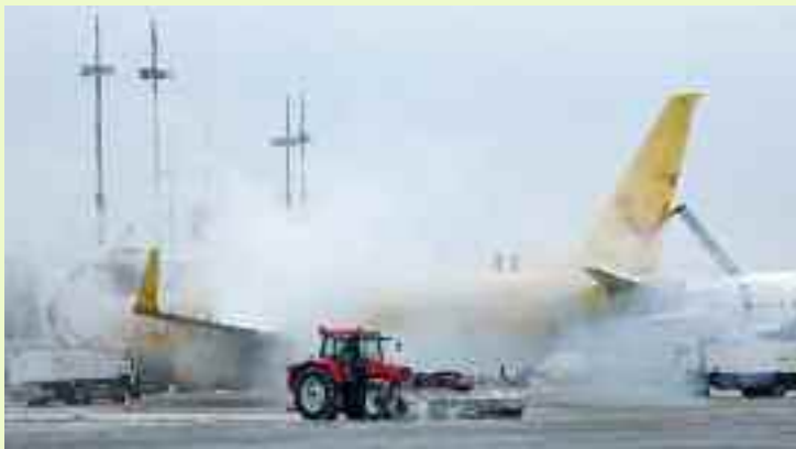
Bei der Enteisierung von Flugzeugen wird weitmöglichst heißes Wasser eingesetzt, um den Verbrauch an Enteisierungsmitteln zu minimieren
