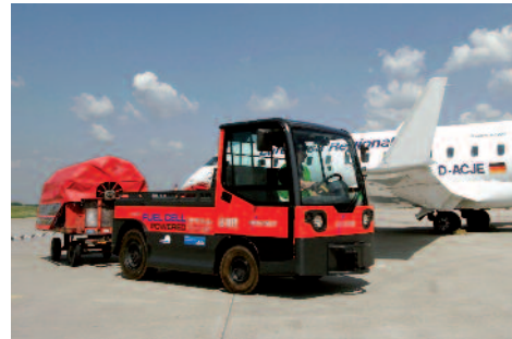
Ein mit einer Brennstoffzelle ausgestatteter Schlepper bringt Gepäck zum Flugzeug
