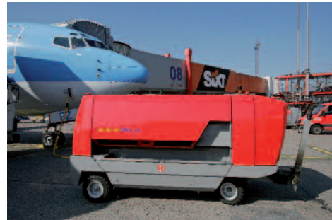
Externe Generatoren versorgen die Flugzeuge am Boden mit Strom – leise und umweltfreundlich
