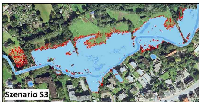
Abb. 5.4.5: Überschwemmte Flächen im Wandse Einzugsgebiet eines Hochwasserereignisses mit einer Wiederkehrzeit von einmal in 100 Jahren für ein Klimaszenario mit starken Auswirkungen und drei städtebaulichen Szenarien für 2050. Szenario 1: ohne DRWB-Maßnahmen; Szenario 2: teilweise Umsetzung von DRWB-Maßnahmen; Szenario 3: großflächige Umsetzung von DRWB-Maßnahmen.
