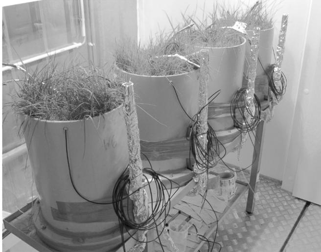
Abb. 8.6: Klimakammer mit Auenboden-Lysimetern
