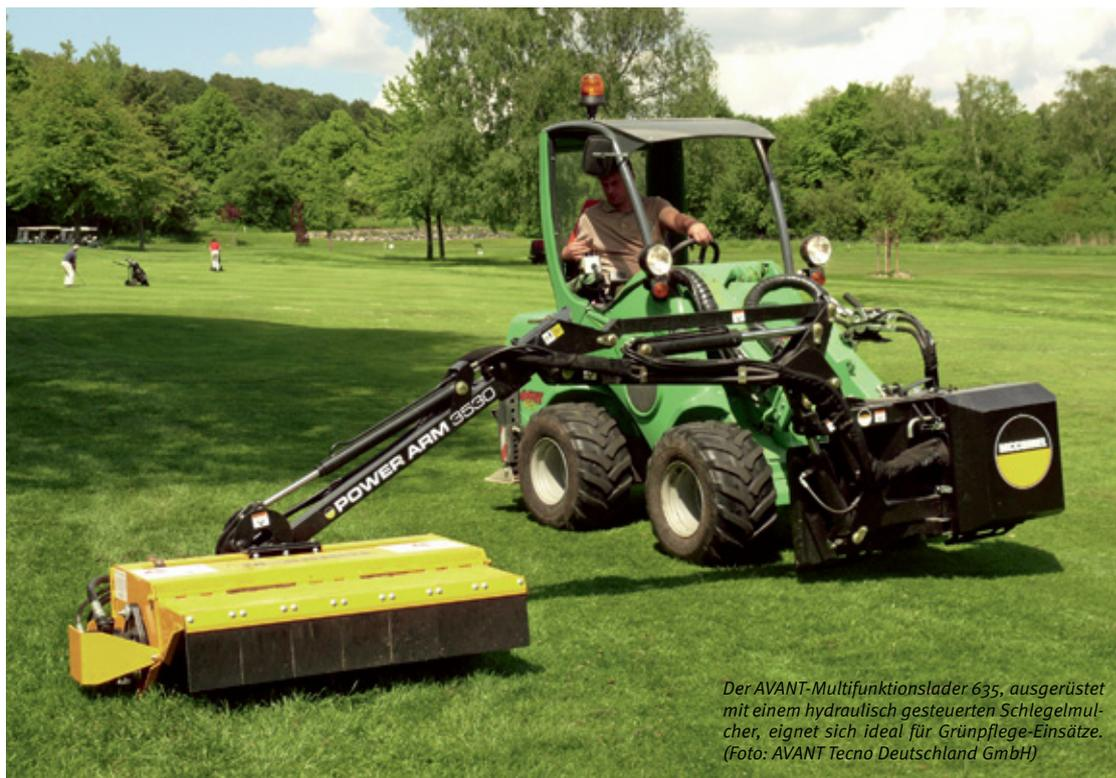
Der AVANT-Multifunktionslader 635, ausgerüstet mit einem hydraulisch gesteuerten Schlegelmulcher, eignet sich ideal für Grünpflege-Einsätze. (Foto: AVANT Tecno Deutschland GmbH)
