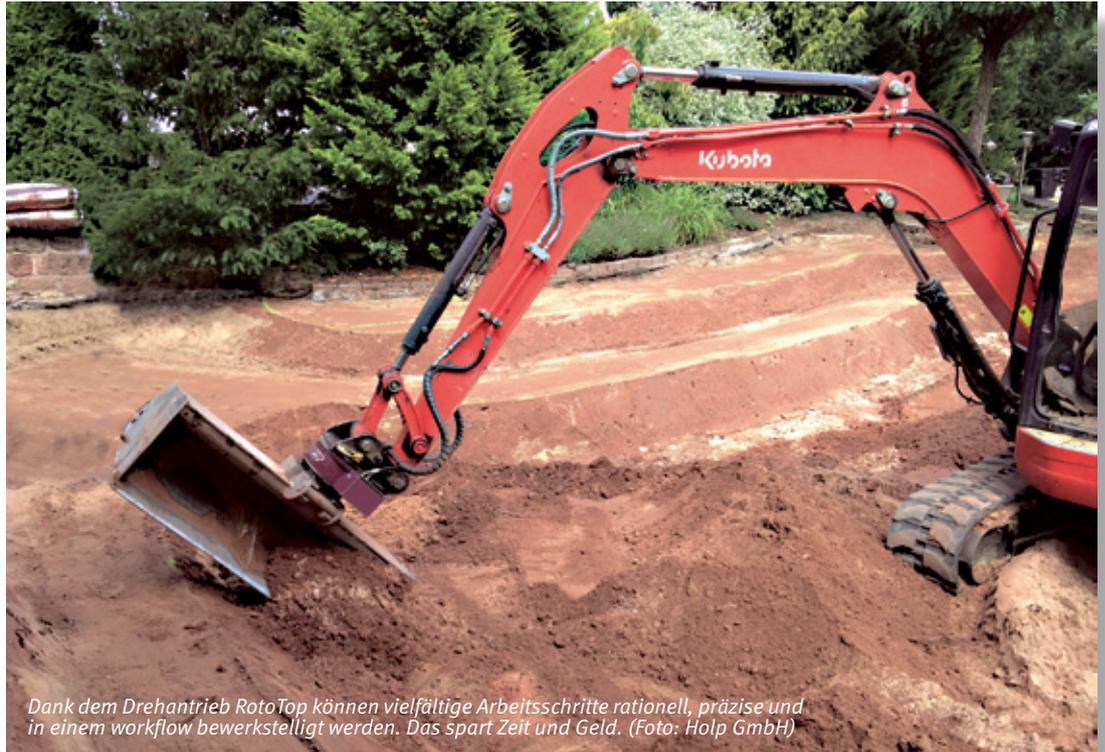
*Dank dem Drehantrieb RotoTop können vielfältige Arbeitsschritte rationell, präzise und in einem workflow bewerkstelligt werden. Das spart Zeit und Geld. (Foto: Holp GmbH)*
