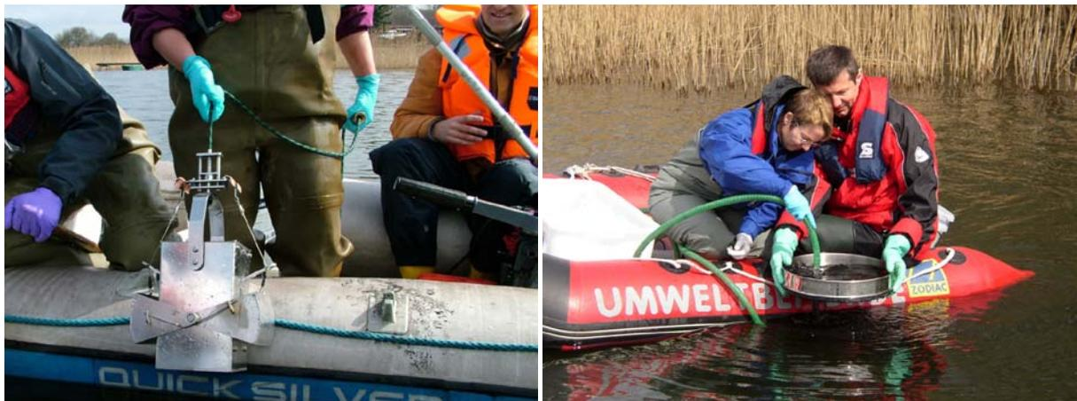
Abb. 1: Makrozoobenthosbeprobung im Sublitoral von Stehgewässern: links Probenahme mit dem Birge-Ekman-Greifer; rechts Sieben, Spülen und Einengen der Probe.
