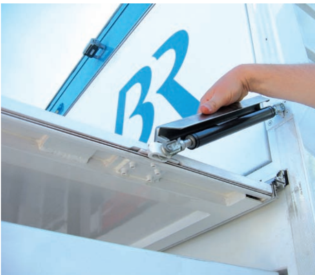
Abbildung 3: Mechanische Verriegelung der Gasdruckfeder
