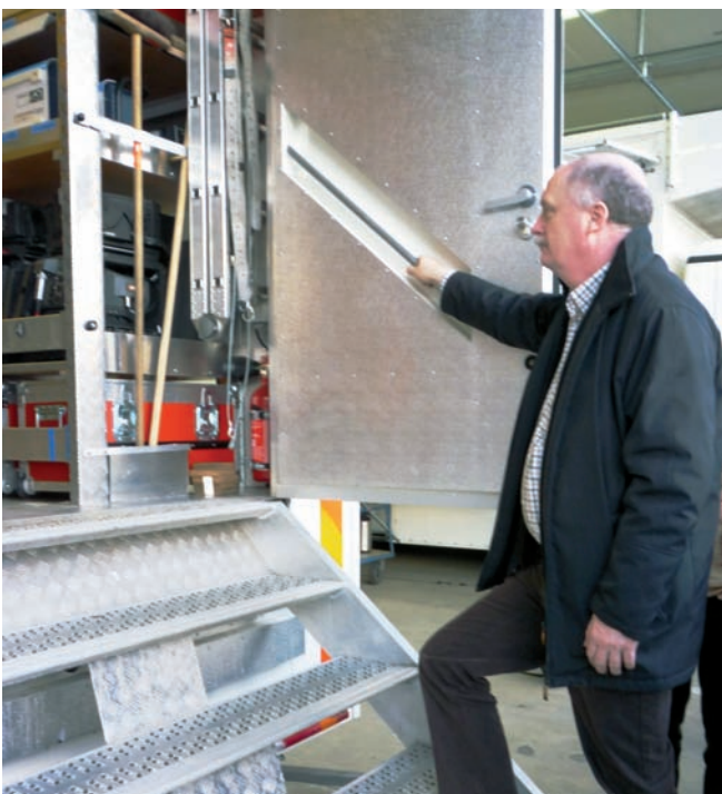
Abbildung 5: Fahrzeugtreppe, Handlauf in Tür integriert
