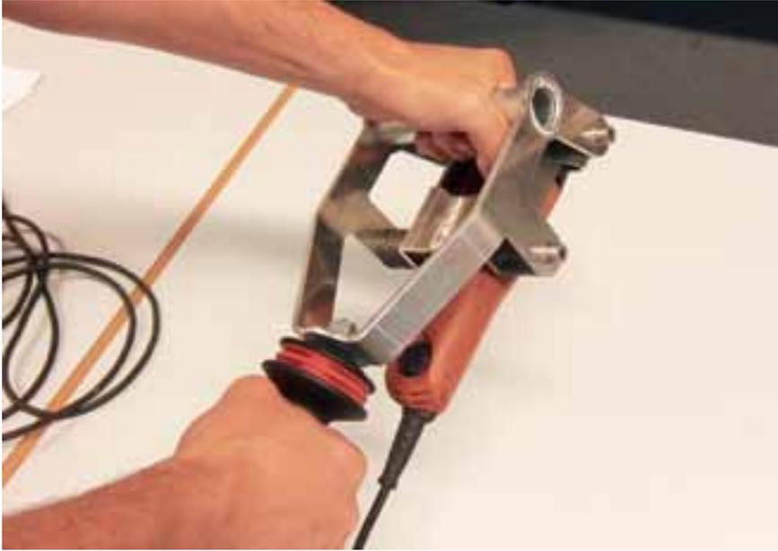
Mit einer vibrationsmindernden Haltevorrichtung – hier ein Prototyp – können Hand-Arm-Vibrationen deutlich gemindert werden.
