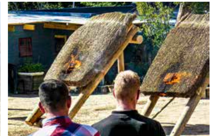
Zum Konferenzprogramm gehörten auch Brandtests an unterschiedlichen, vorgefertigten Musterflächen.
