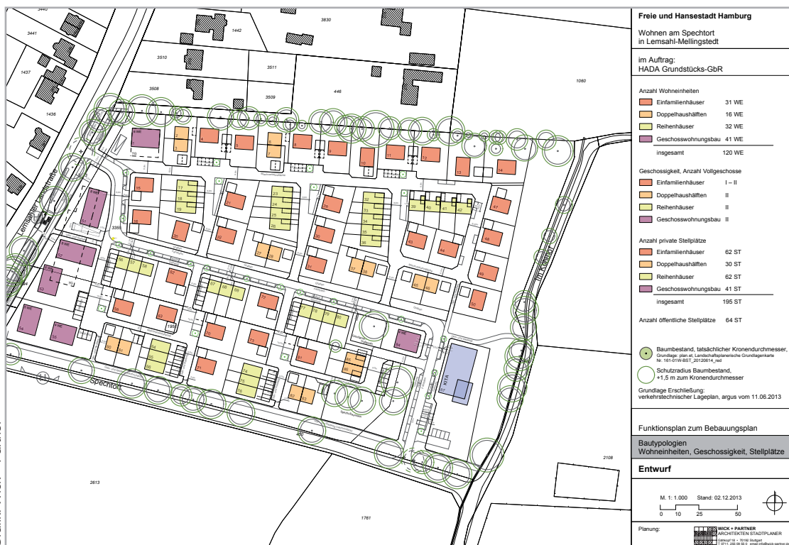
Funktionsplan zum Bebauungsplan Spechtort (Lemsahl-Mellingstedt 20) mit Bautypologien, Wohneinheiten, Geschossigkeit und Stellplätzen
