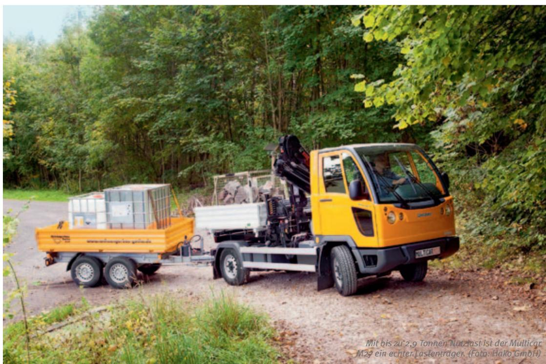
Mit bis zu 2,9 Tonnen Nutzlast ist der Multicar M27 ein echter Lastenträger. (Foto: Hako GmbH)
