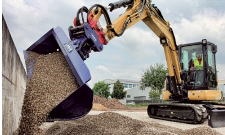
Wendig und flexibel mit der Lehnhoff 3er-Kombi aus vollhydraulischem Variolock-Schnellwechsler, Symlock-Adapter und Schwenklöffel. (Foto: Lehnhoff Hartstahl GmbH & Co. KG)
