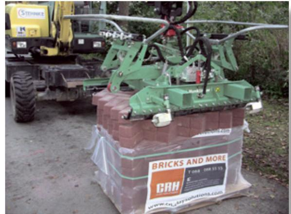
von Fischgrät 45° kann dabei eine standardmäßige Hunklinger-Verlegezange eingesetzt werden, die in diesem speziellen Fall mit 45°-Adaptoren bestückt wurde.
