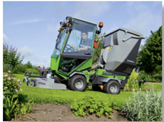
schon können sowohl Grassammelbehälter als auch Filter mit Hilfe eines Hochdruckreinigers im Handumdrehen gesäubert werden.
