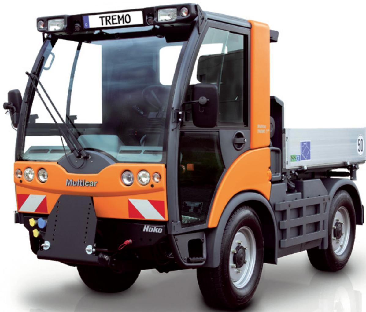
Der Schmalspurgeräteträger Multicar TREMO ist überall dort zuhause, wo es auf Wendigkeit und Flexibilität ankommt. Er wird in drei alternativen Varianten angeboten: als Multicar TREMO T+ mit Einkreis-Hydraulik, als Multicar TREMO C mit Standardhydraulik und als Multicar TREMO CS mit Universal-Hochleistungshydraulik.
