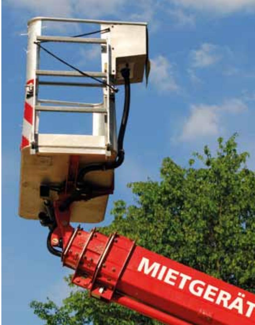
**Funktionsfähigkeit und Sicherheit auch von geliehenen Hubarbeitsbühnen müssen vor jedem Einsatz geprüft werden.**
