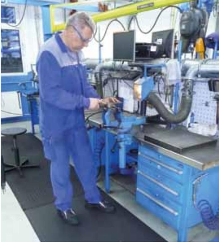
Bei Ardagh Glass aus Bad Münde haben die Steharbeitsplätze in der Werkstatt höhenverstellbare Schraubstöcke, dämmende Fußbodenmatten und einen Hocker zum Sitzen.
