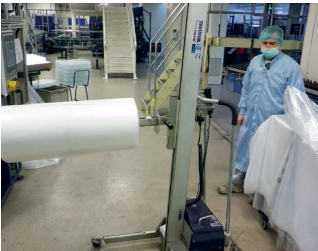
Ein mobiler Hebelift erleichtert den Mitarbeitern das Wechseln der Folienrollen.
