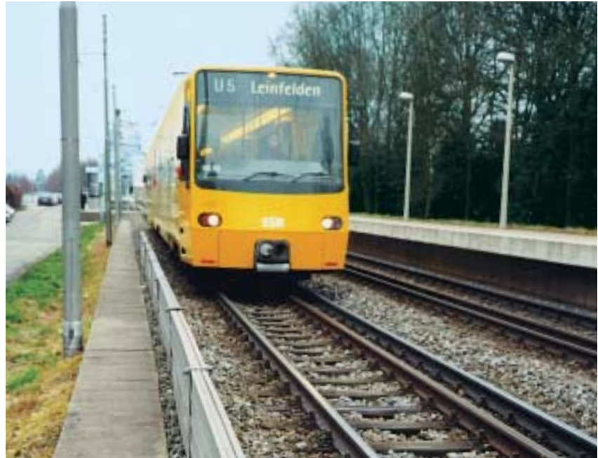
Wenn das Verlassen des Gleises durch Einbauten, wie z. B. Stromschienen oder niedrige Lärmschutzwände, erschwert ist, muss dies bei den Räumzeiten angemessen berücksichtigt werden.
