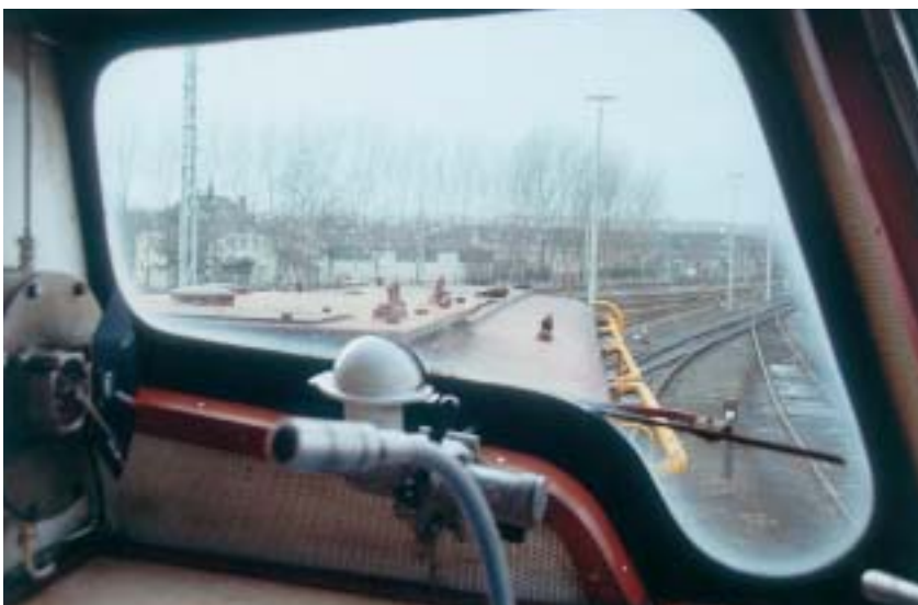
Bei der Festlegung von Sicherungsmaßnahmen muss auch berücksichtigt werden, dass die Sichtverhältnisse bei älteren Lokomotiven oft nur unzureichend sind.
