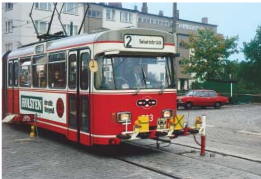
Werden Schranken für die Sicherung von Gleisbaustellen bei Straßenbahnen verwendet, kann auf Sicherungsposten nur verzichtet werden, wenn die Schranke sich nicht selbsttätig oder durch das Schienenfahrzeug gesteuert öffnet.
