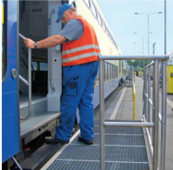
Ist auf der Seite, an der die Einstieghilfe aufgestellt wird, ein benachbartes Gleis, darf der seitliche Sicherheitsabstand des benachbarten Gleises nicht eingeschränkt werden.
