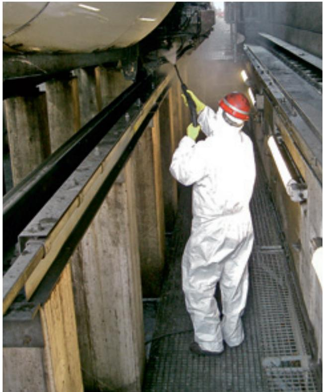
Die Arbeitsgruben sollen als Mittel- und Seitengruben ausgeführt werden, um optimale Arbeitspositionen zu ermöglichen.
