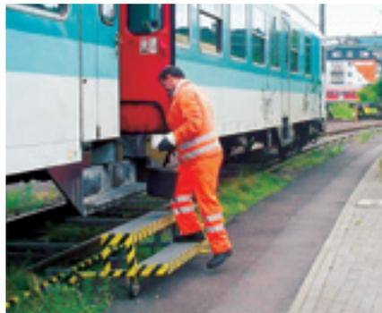
Diese längsverfahrbare spurgeführte Einstieghilfe ist für Fahrzeuge mit unterschiedlichen Türanordnungen geeignet.
