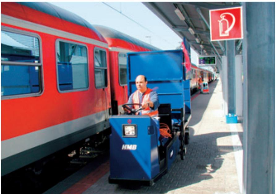
Werden Flurförderzeuge in Innenreinigungsanlagen eingesetzt, ergibt sich die Verkehrswegbreite aus der Breite des Fahrzeuges bzw. des Ladegutes zuzüglich der Randzuschläge für gemeinsamen Personen- und Fahrverkehr.
