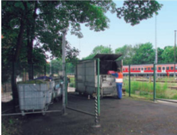
Der Entsorgungsplatz muss entsprechend der anfallenden Abfallmengen, der Fraktionierung und der Abfuhrhäufigkeit unter Berücksichtigung von Reserveflächen bemessen werden. Er ist möglichst in der Nähe der Innenreinigungsgleise anzuordnen. Bei größeren Entfernungen muss der Transport mit Flurförderzeugen, z. B. Plattformwagen, Handkarren, erfolgen. Eine unbefugte Benutzung soll durch Einzäunen und/oder Sichtschutz gegenüber öffentlichen Bereichen erschwert werden.
