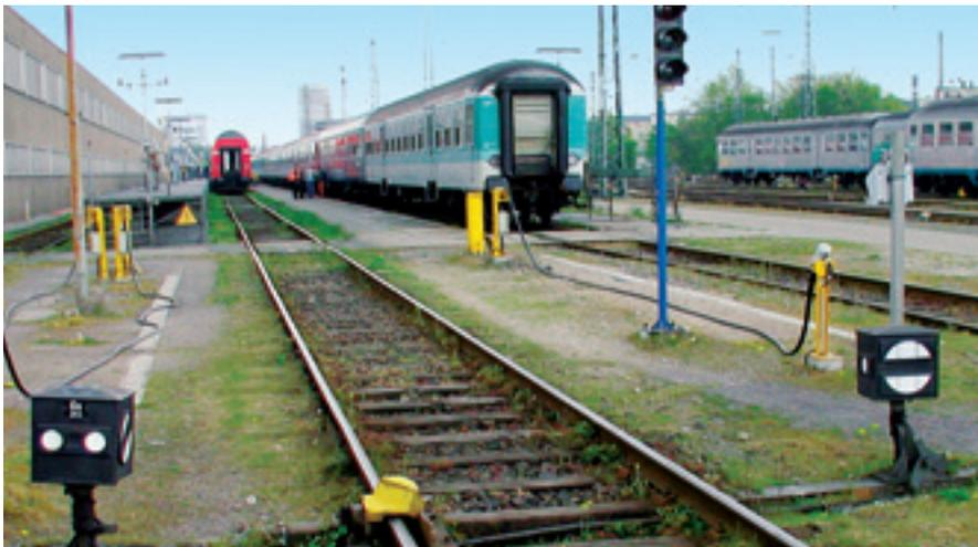
Dieses Reinigungsgleis wird durch eine ortsbediente Gleissperre gegen auffahrende und auf laufende Eisenbahnfahrzeuge gesichert.
