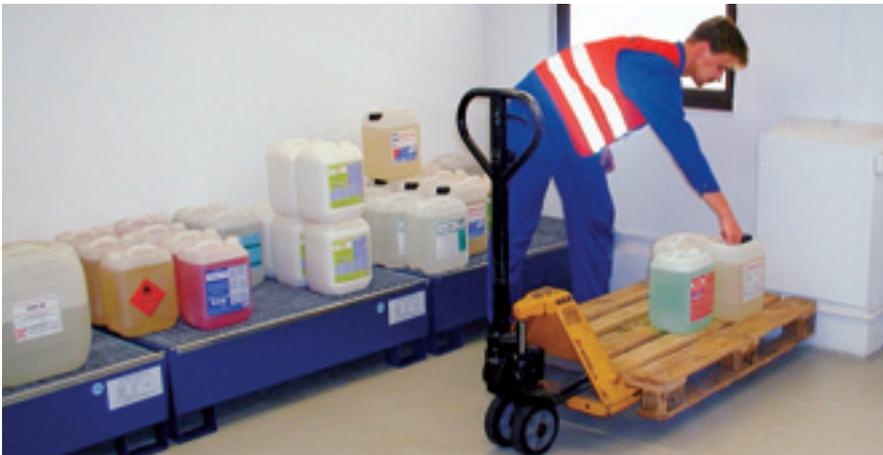
Bei ausreichender Bemessung der Lagerflächen und Verkehrswege können Transporthilfsmittel, z. B. Gabelhubwagen, zur Verringerung der Tragearbeiten eingesetzt werden.
