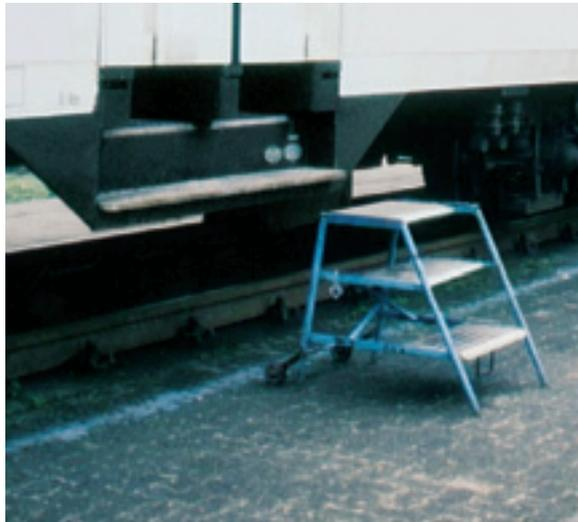
Die Anzahl der Einstieghilfen ist abhängig von den Arbeitsabläufen bei den Reinigungsarbeiten. Grundsätzlich sind vor jeder Außentür der zu reinigenden Eisenbahnfahrzeuge Einstieghilfen bereitzustellen. Auf Einstieghilfen vor Außentüren darf nur dann verzichtet werden, wenn
