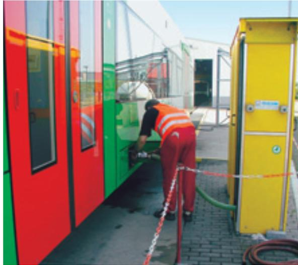
ausgeführt werden muss. In der Regel werden in Innenreinigungsanlagen daher Bühnen nur auf einer Seite und die Trinkwasserfüll- und Fäkalienentsorgungsanlagen auf der anderen Seite errichtet. Um Verunreinigungen der Trinkwasser-schläuche auszuschließen, darf die WC-Entsorgung nicht gleichzeitig mit der Trinkwasserfüllanlage betrieben werden. Dies kann z. B. durch eine gegenseitige Verriegelung der Ver- und Entsorgungssysteme sichergestellt werden.
