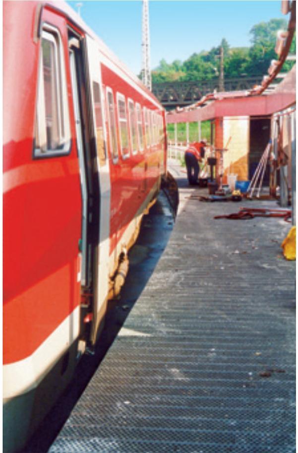
Innenreinigungsbühnen sind grundsätzlich in geraden Gleisen zu errichten. An dieser Arbeitsbühne überschreitet der Spalt zwischen der Außenkante der Bühne und dem Fahrzeug wegen des Gleisbogens die max. zulässigen 0,2 m.
