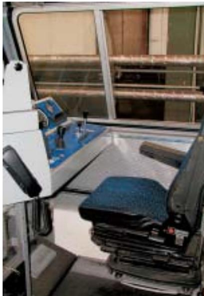
Werden Loks auch mit Funkfernsteuerung gefahren, sind die Betätigungselemente auf dem Fahrpult weitgehend analog denen auf dem tragbaren Steuergerät anzurorden.
