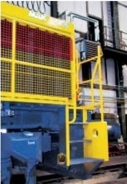
Bei Rangierlokomotiven sind an den Stirnseiten möglichst tief über SO, mit guten Festhaltungsmöglichkeiten ausgestattete und geschützt hinter der Pufferbohle angeordnete Standflächen für Lokrangierführer und Rangierer vorzusehen.
