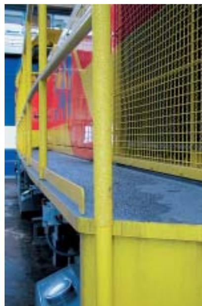
Rutschhemmende Beschichtungen von außenliegenden Griffstangen und Laufflächen sind bei neuen Lokomotiven Stand der Technik.
