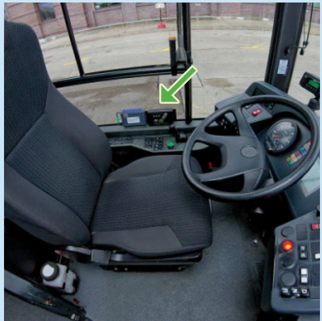
Abbildung 15: Fahrersitz mit Speicherfunktion und Verstell-einheit (grüner Pfeil)
