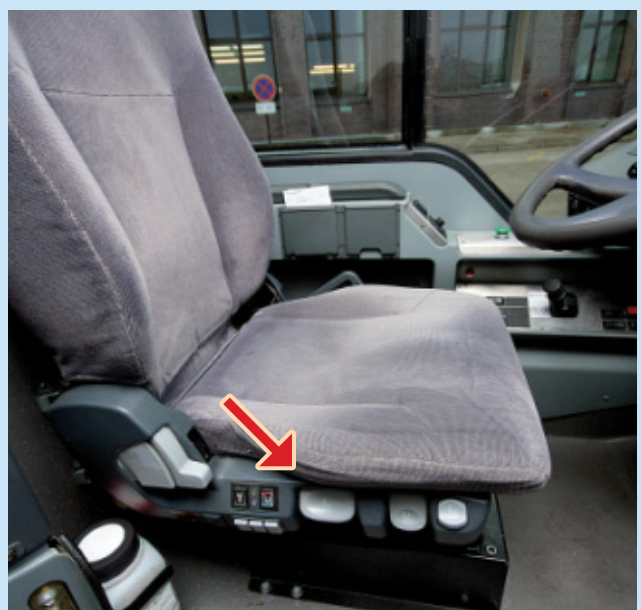
Abbildung 16: Konventioneller Fahrersitz mit manuell zu betätigenden Stellteilen (roter Pfeil)
