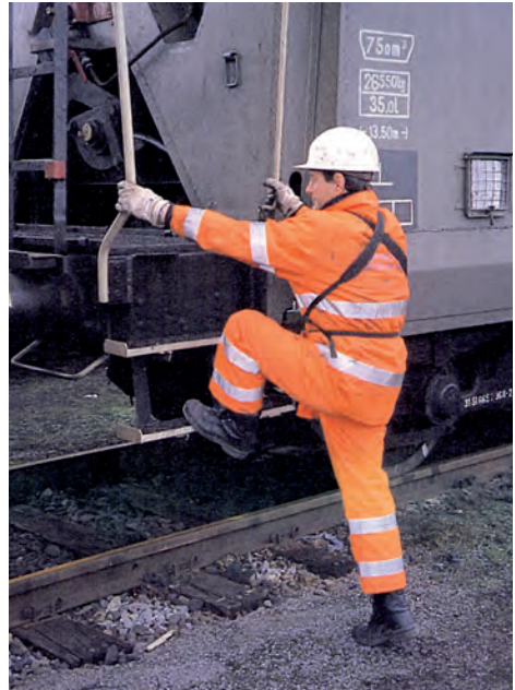
Abbildung 4: Längere Wagengruppen, die beim Überqueren von Gleisanlagen im Wege stehen, können vom Rangierer auf der Endbühne eines Waggons überquert werden. Auf keinen Fall steigt er über die Puffer oder kriecht er unter den Wagen hindurch.
