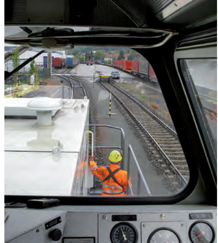
Abbildung 7: Wird funkferngesteuert gefahren, kann der Lokrangierführer bei gezogener Fahrt den Gleisbereich unmittelbar von der Spitze aus besser beobachten als vom Mittelführerstand des Triebfahrzeuges.
