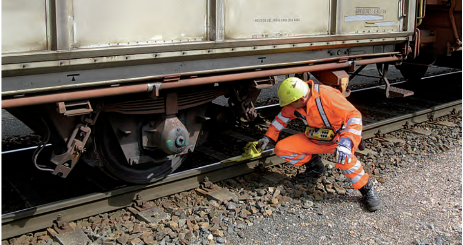
Abbildung 15: Der Rangierer sichert einen Wagen gegen Abrollen durch Auflegen eines Hemmschuhes.
