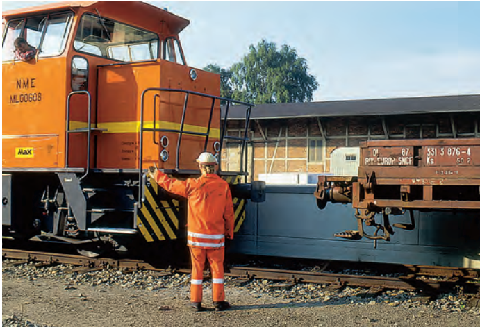
Abbildung 11: Beim anzukuppelnden Wagen ist der freie Raum durch die heruntergeklappte Stirnwand eingeschränkt. Deshalb lässt der Rangierer zunächst das Triebfahrzeug heranzufahren, bis die Puffer sich berühren. Erst dann begibt er sich zum Kuppeln zwischen die Fahrzeuge.
