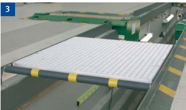
3 Abdeckung Verschiebbarer Übergang für lange Gruben
