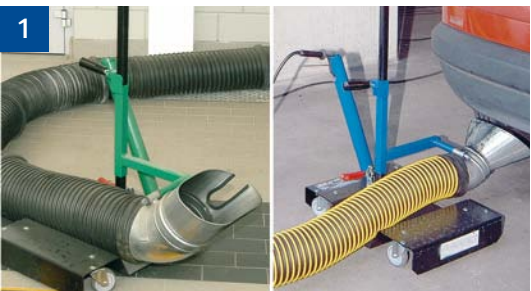
1 Erfassungstrichter für AU mit Stativ
