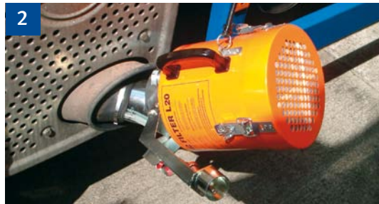
2 Partikelfilter für Lkw im Einsatz
