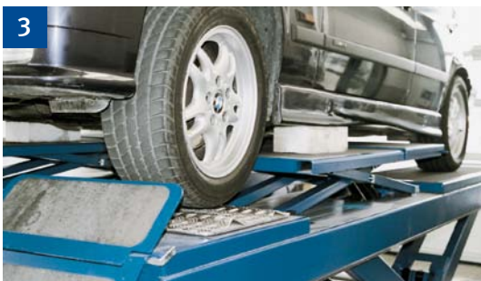
Integrierter Achsspieltester, Radfreiheber und Sicherung gegen Wegrollen
