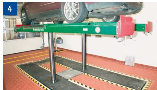
Zweistempel-Hebebühne mit integriertem Bodenausgleich
