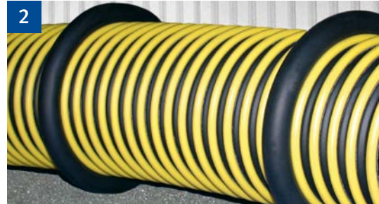
Ringe an den Absaugschläuchen erhöhen die Lebensdauer und sparen Instandhaltungskosten
