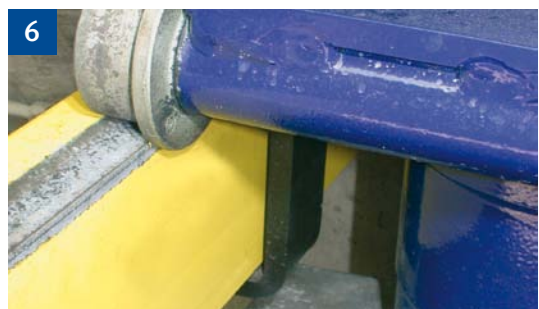
Kippsicherung des Fahrwagens
