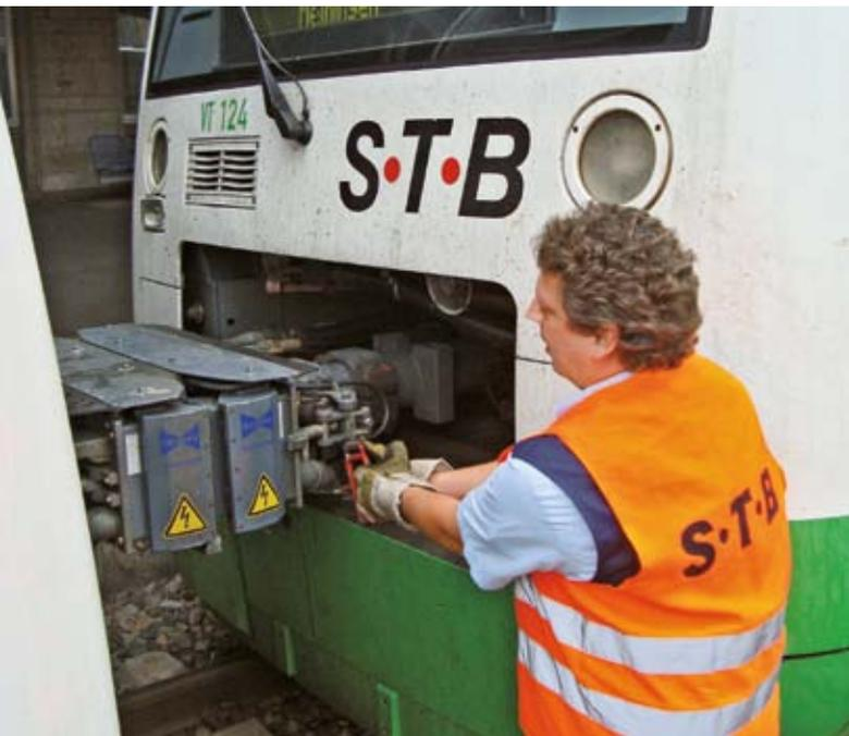
Bei der Notlösung dieser automatischen Kupplung muss keine Anstoßkappe getragen werden. Warnweste, Handschuhe und trittsichere Schuhe sind aber auch in diesem Fall erforderlich.
