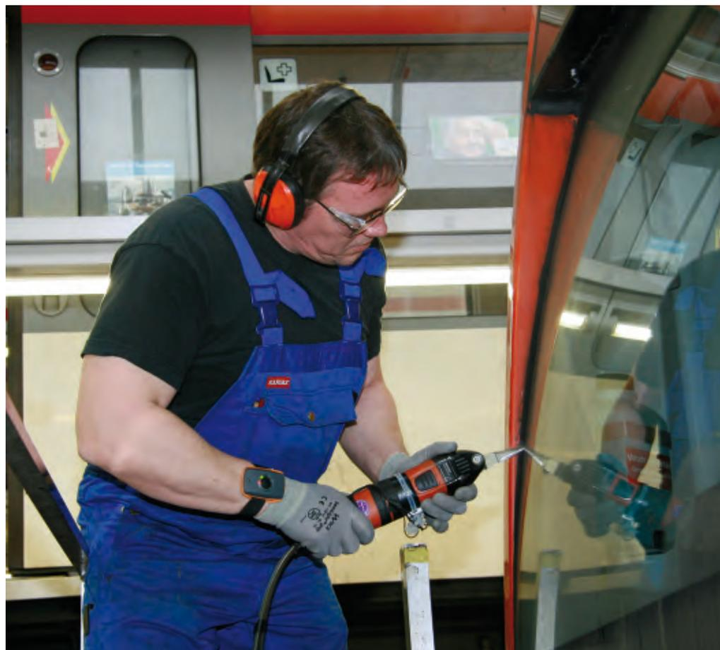
Immer häufiger und länger andauernd werden oszillierende Messer bei Instandhaltungsarbeiten in Werkstätten – zum Beispiel für das Heraustrennen von Fahrzeugscheiben – verwendet. Die Belastungen durch Hand-Arm-Vibrationen sind ohne Schutzmaßnahmen sehr hoch.
