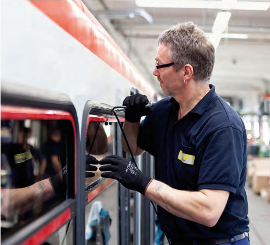
Der Ein- und Ausbau in Profilgummi eingesetzter Scheiben erfolgt vibrationsfrei.
