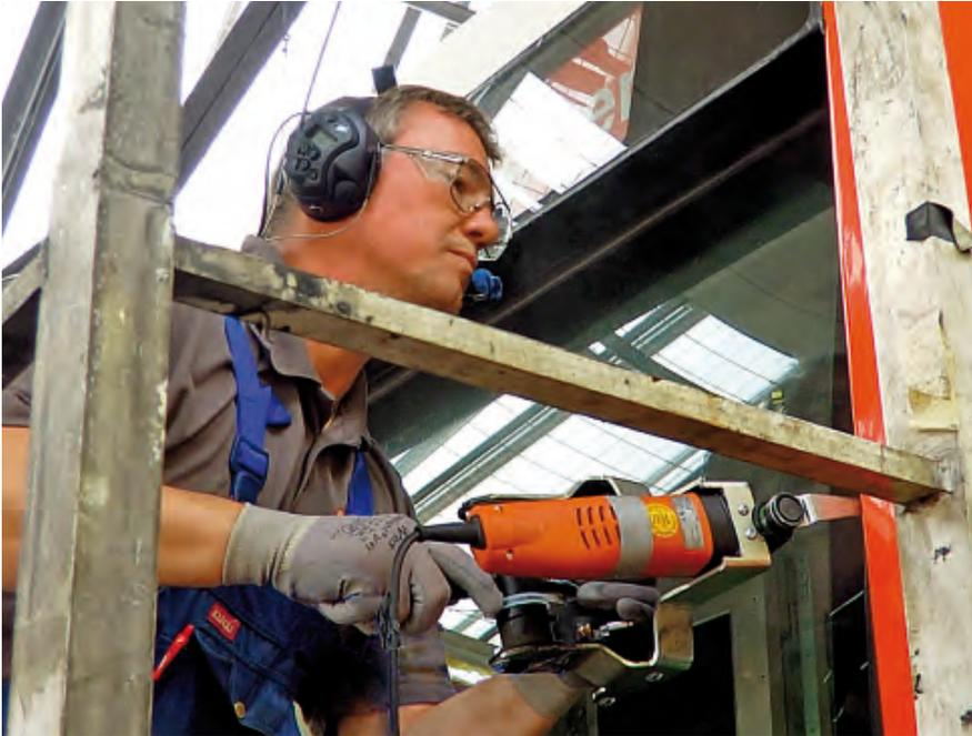
Handelsübliche Geräte können mit einer schwingungsdämpfenden Spezialkonstruktion nachgerüstet werden. Die Gummielemente zwischen Rahmen und Gerät vermindern die Vibrationsbelastung.
