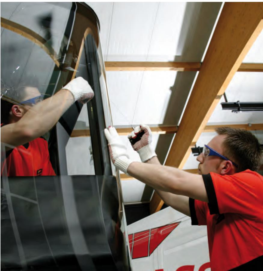
Mithilfe der mit Saugnäpfen auf der Scheibe fixierten Kurbel kann der Schneidedraht ohne großen Kraftaufwand durch die Klebemasse gezogen werden.
