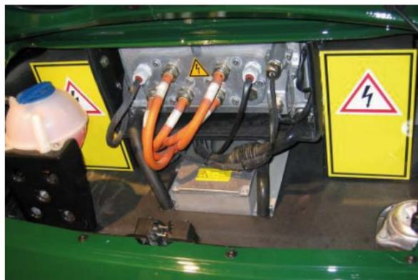
Abbildung 1: HV-Kabel
