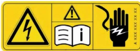
Abbildung 2: Beispiel für die Kennzeichnung von HV-Komponenten
