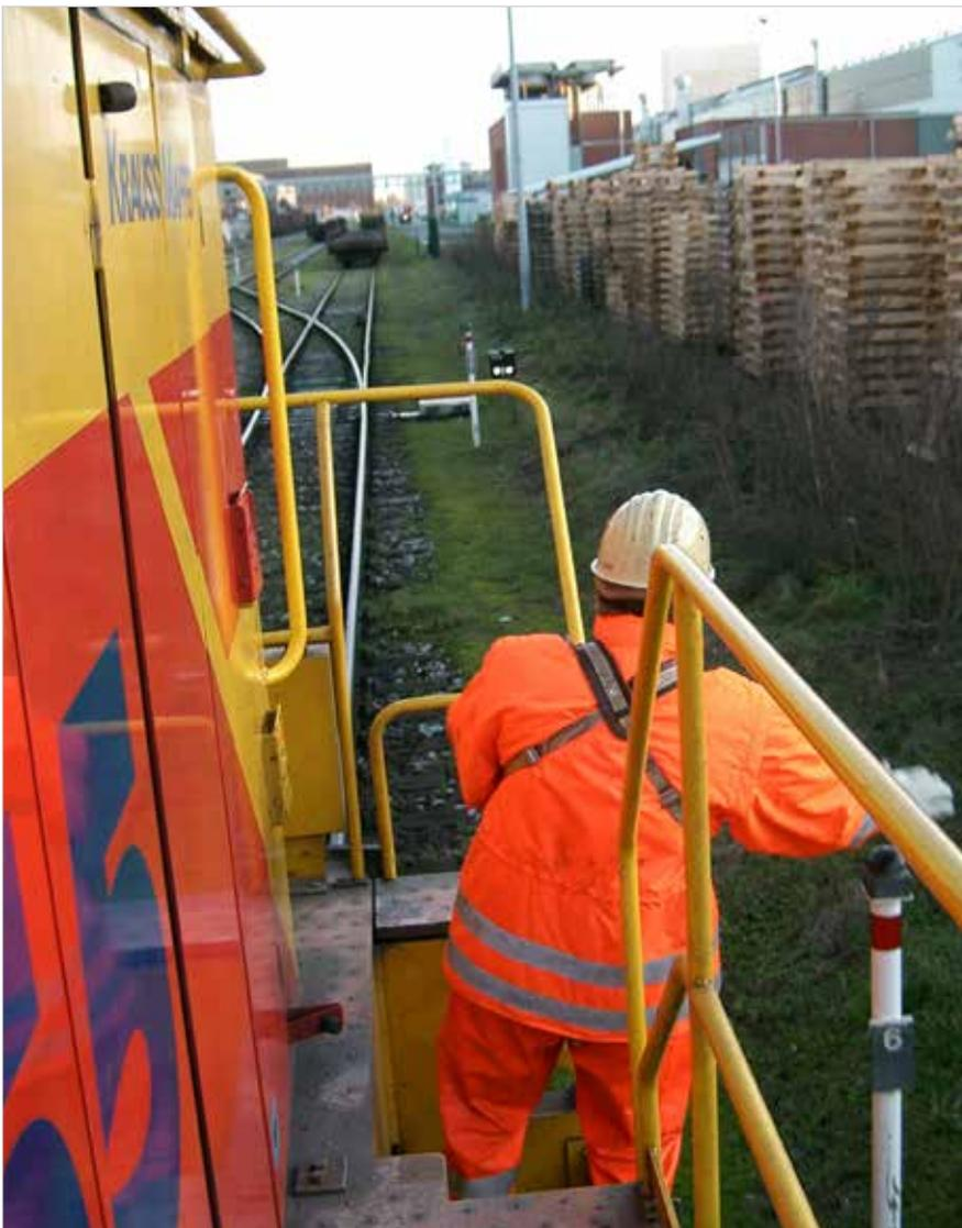
Wird funkferngesteuert gefahren, kann der Lokrangierführer den Gleisbereich vom Mitfahrerstand aus gut beobachten.
