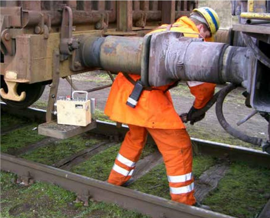
Zum Kuppeln setzt dieser Lokrangierführer den Sender auf dem Endtritt ab, um bequem unter dem Puffer hindurchzutauchen. Das darf er nur, wenn er zuvor sichergestellt hat, dass sich das Triebfahrzeug nicht unbeabsichtigt bewegen kann.
