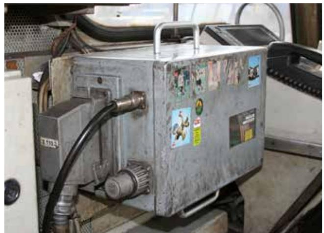
Durch Umsetzen eines Adresssteckers von der Adressprüfung auf dem Mittelführerpult des Triebfahrzeuges auf den Sender und des anderen Adresssteckers auf den Empfänger des Triebfahrzeuges werden bei diesem System Sender und Empfänger einander zugeordnet.
