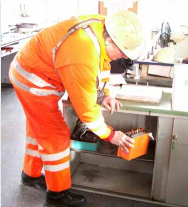
Beim Beenden des Funkfernsteuermodus ist der Sender unter Verschluss zu nehmen.
