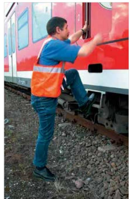
Immer wieder muss direkt vom Gleis aus eingestiegen werden. Sichere Tritte und Griffe sind deshalb unerlässlich.
