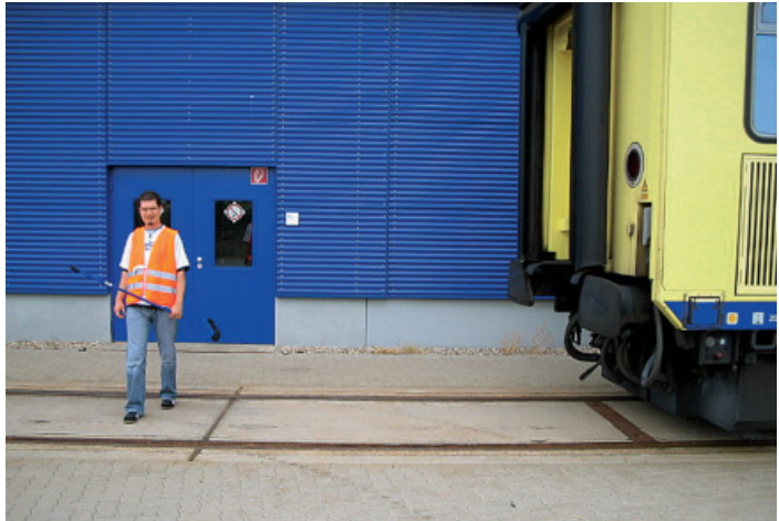
Abbildung 6: Gleise dürfen nur überquert werden, wenn der Abstand zu stehenden Eisenbahnfahrzeugen mindestens 2 m beträgt.
