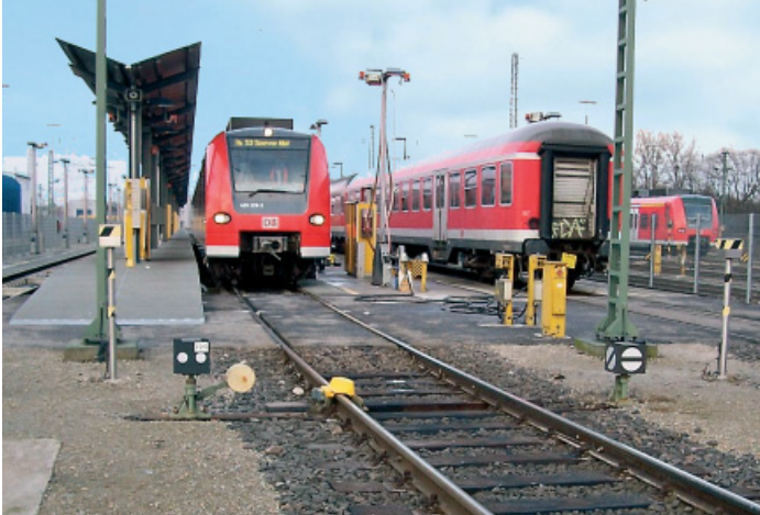
Abbildung 13: Eine Gleissperre verhindert wirksam, dass andere Eisenbahnfahrzeuge auf die zu reinigende Einheit auffahren.
