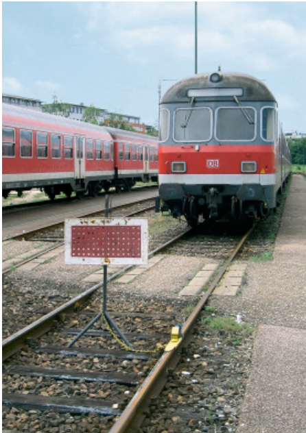
Abbildung 14: Bewährt hat sich, die Sh2-Tafel in Verbindung mit einem Hemmschuh einzusetzen. Damit der Hemmschuh beim Aufheben der Gleissperrung nicht vergessen werden kann, ist er durch eine Kette mit der Sh2-Tafel verbunden.
