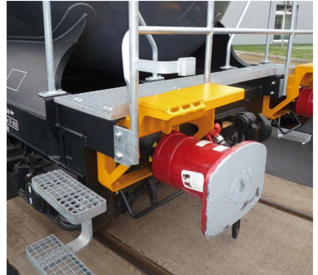
Aufprallschutz: Die gelbe Platte verhindert ein Abgleiten der Puffer in den Laderaum
