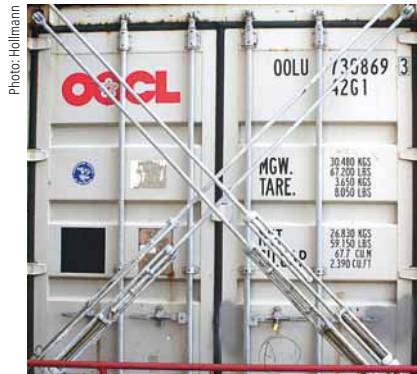
SICHERUNG. An den unteren Lagen sind Stangen aus hochfestem Stahl kreuzweise verschraubt.
