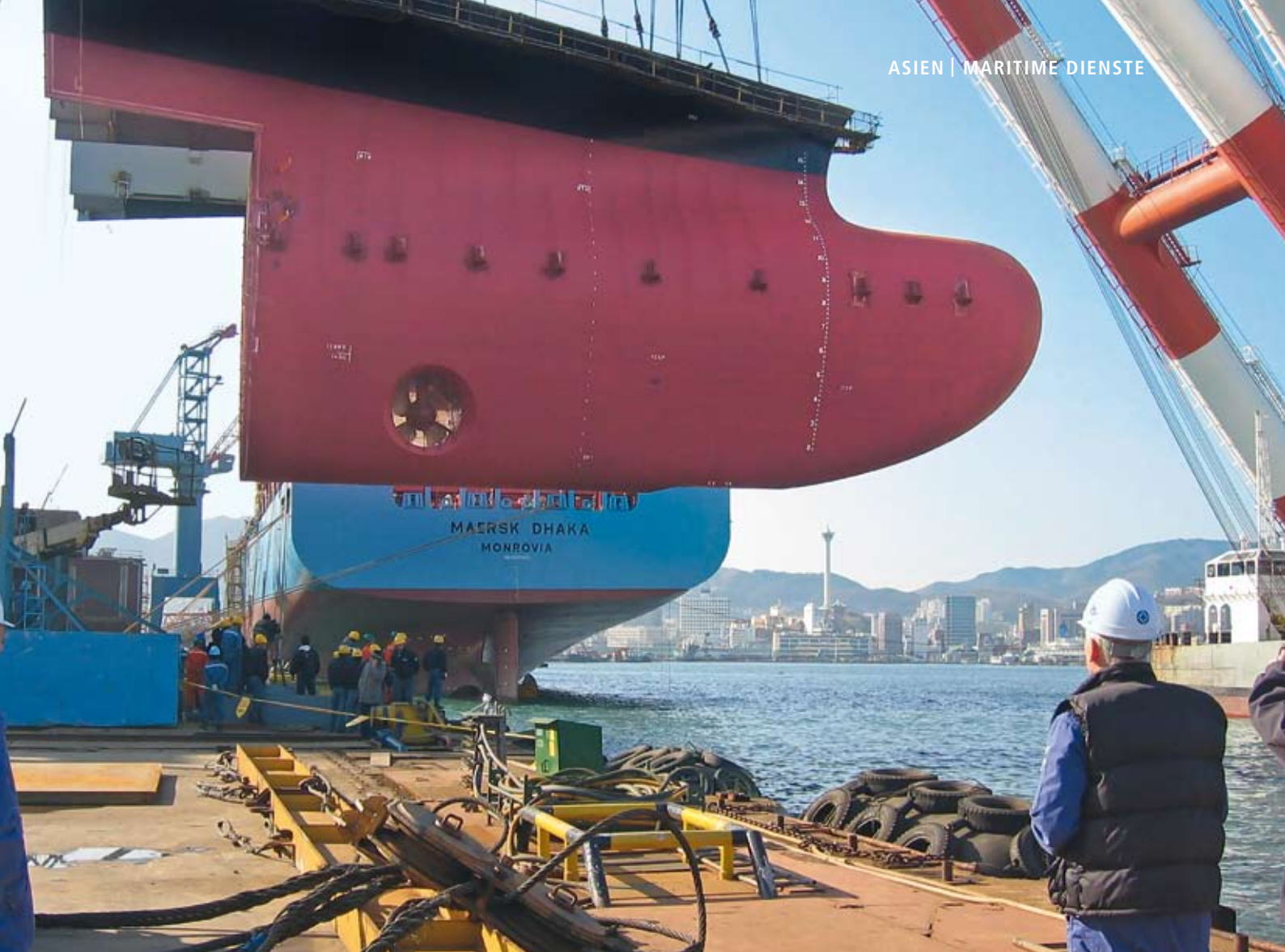
BAUKASTEN. Bei Hanjin wird ein Schiff nach dem „DAM“-System zusammengesetzt. Rumpf und Bugabschnitt werden separat gefertigt und dann zusammengeschweißt – so entstehen Schiffe, die größer als das Dock sind.
