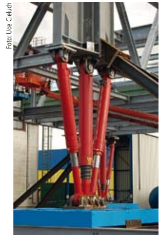
TECHNIK. Die Hydraulikbeine sollen das Versinken im Eis verhindern.
