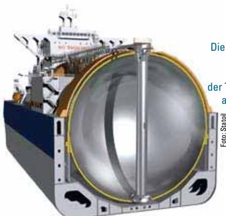
KLASSIKER. Die Kugeltanks reduzieren die Bauzeit der Tanker, sind aber schwer.
