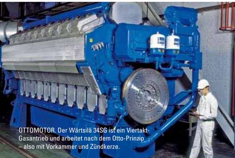
OTTOMOTOR. Der Wärtsilä 34SG ist ein Viertakt-Gasantrieb und arbeitet nach dem Otto-Prinzip – also mit Vorkammer und Zündkerze.
