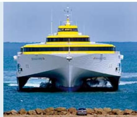
LEICHTBAU. Der schnelle Trimaran „Benchijigua Express“ besteht komplett aus Aluminium.
