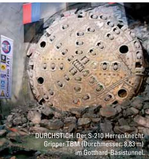
**DURCHSTICH.** Der S-210 Herrenknecht Gripper TBM (Durchmesser: 8,83 m) im Gotthard-Basistunnel.
