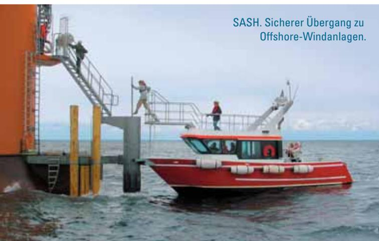
SASH. Sicherer Übergang zu Offshore-Windanlagen.
