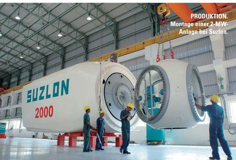
**PRODUKTION. Montage einer 2-MW-Anlage bei Suzlon.**
