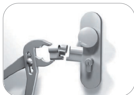
Altbeschlag mit herausragendem Zylinder
