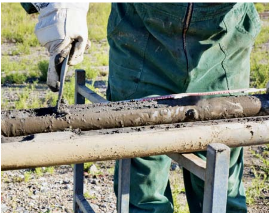
Bodenansprache zur Ermittlung der Lage der Weichschichten
