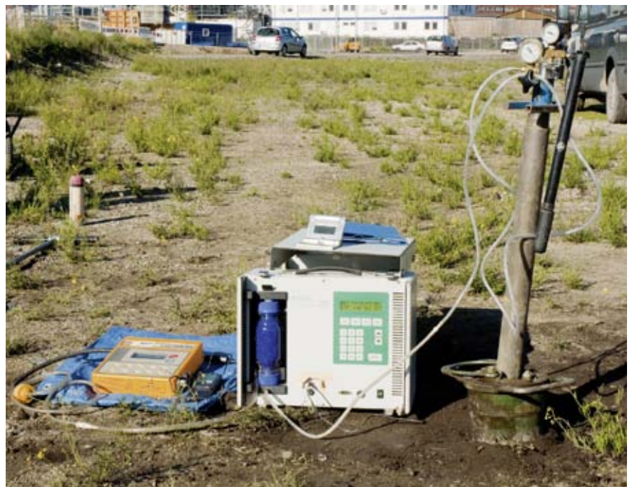
Messsystem bestehend aus Packersonde, Pumpe und Deponiegasanalysator
