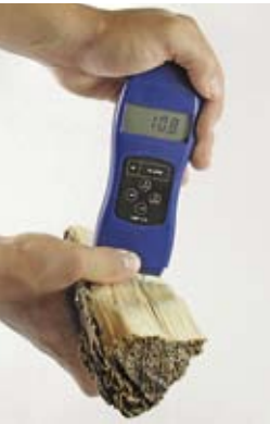
Messung des Wassergehaltes mit einem Schnellbestimmungsgerät
