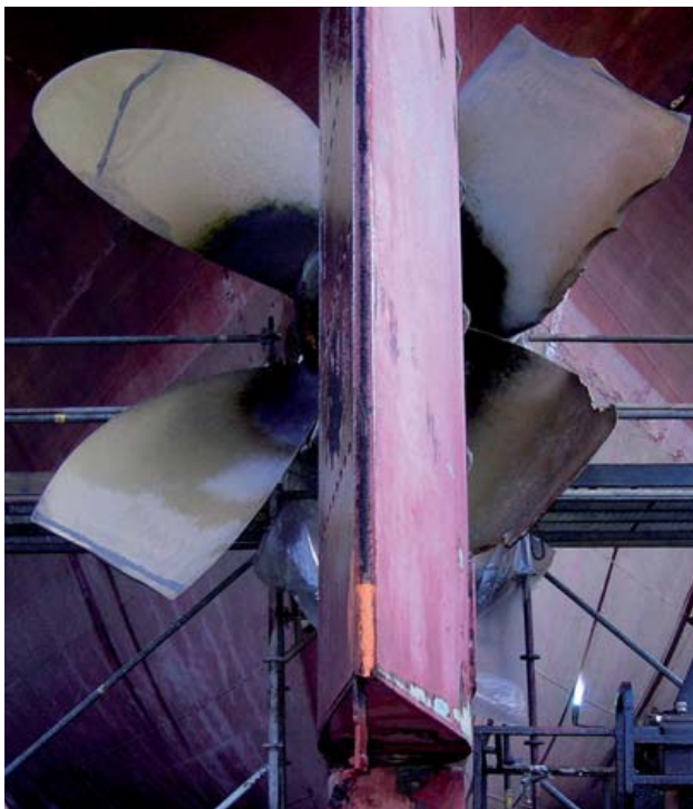
Schiffsschraube mit zwei abgeschnittenen Propellern
