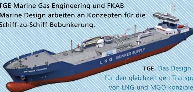
TGE. Das Design ist für den gleichzeitigen Transport von LNG und MGO konzipiert.
