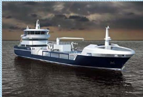
**FKAB.** Das Schiff wird mit zwei Motoren ausgerüstet und kann mit LNG und Biogas betrieben werden.
